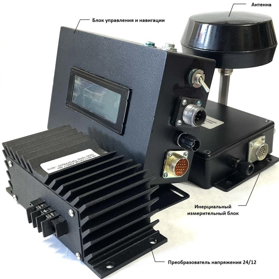
Рис.5. Общий вид ГАЛС-М1АМ исп.4 ПРЦЛ.461524.200-04
